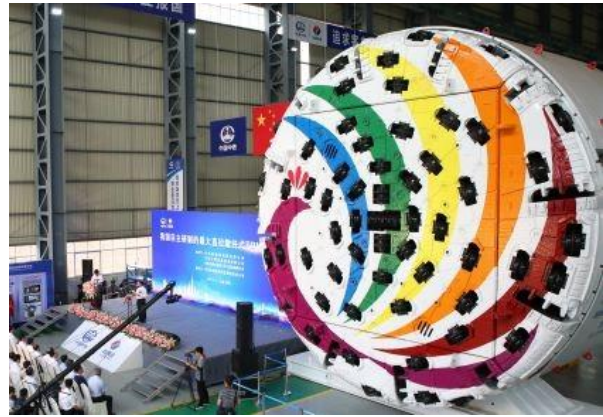
图 35：国内最大直径硬岩掘进机（TBM）“彩云号”
