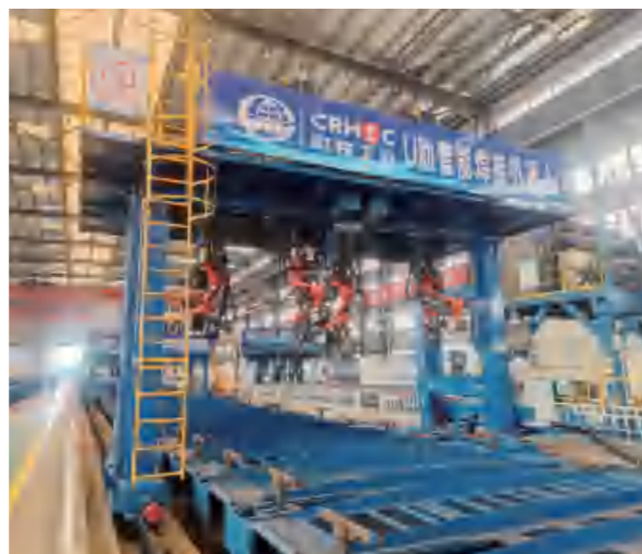
公司所属中铁宝桥扬州公司引进 U 肋智能焊接机器人设备，提高了生产自动化水平，提高了能源利用效率。
