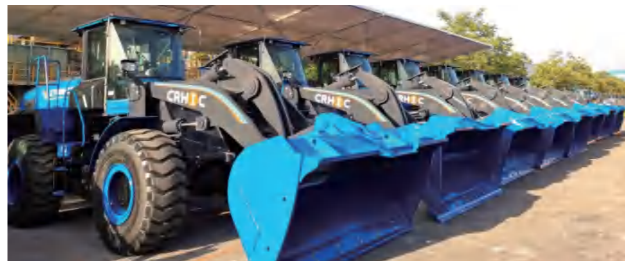
公司所属中铁科工研发的新型纯电装载机成功用于宝武集团新疆天山钢铁厂，助力钢铁企业实现绿色发展。该 ZT968-EV 装载机采用纯电替代柴油燃料，装载机运行和液压电机控制均由电力驱动，可提高能源动力功效 10% 以上，能耗成本仅为柴油装载机的 1/3。按照每年 5000 小时作业时间计算，每台 6 吨电动装载机一年可节省 30 余万元，减少二氧化碳排放超过 150 吨。
